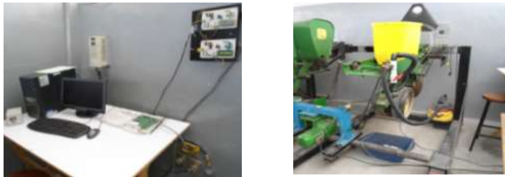
Figura 8. Sistema para la evaluación de dosificadores neumáticos en tiempo real
