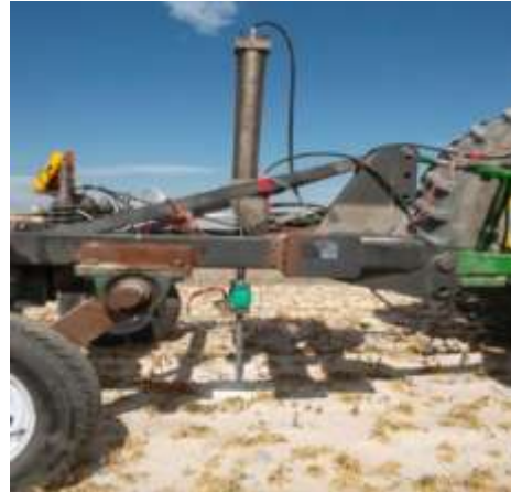
Figura 6. Arreglo del carro porta sensores para determinar la resistencia a la penetración mediante una sonda de cono
