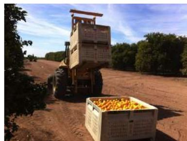
Imagen 12. Montacargas especializado uso agrícola marca Harlo.
